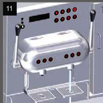
Rinçage externe automatique : un rinçage externe d'env. 25 s du système de lait débutera 5 min après la dernière préparation de boisson à base de lait.
