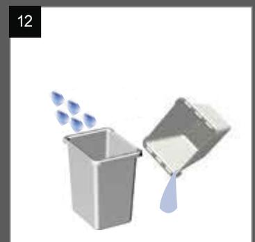
Videz l'eau résiduelle, nettoyez le réservoir de lait de 5 l en lave-vaisselle. Remplacez le(s) réservoir(s) de lait vides dans le réfrigérateur.
