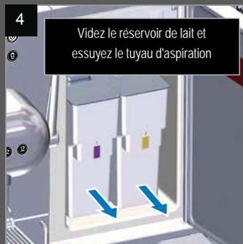
Retirez soigneusement le(s) réservoir(s) de lait et videz-le(s).
